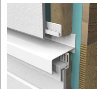
Separación entre plantas si la fachada mide > 5,9 m de altura
