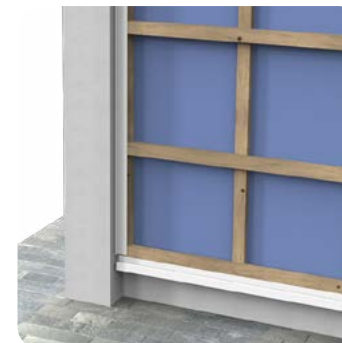
Doble rastrelado (triple con aislamiento) para asegurar la ventilación
