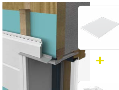
Remate de coronación ventilado + Panel plano
